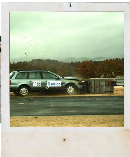
**LE DISPOSITIF P4 NE LAISSE ENTRER AUCUN COMPOSANT DANS LE VEHICULE LORS DE L'IMPACT**
