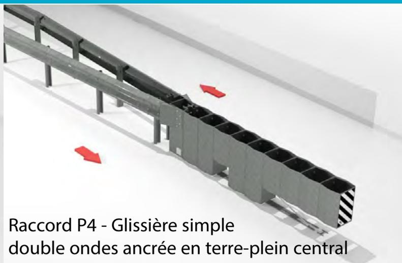
Raccord P4 - Glissière simple double ondes ancrée en terre-plein central
